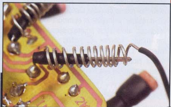
▶ Détails de réalisation des antennes "contact"
